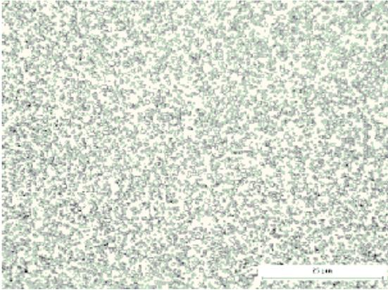
Figure 1. Sandvik 13C26 'as delivered', unhardened.
